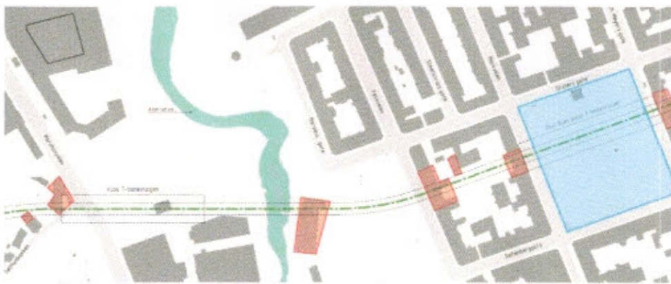
Figur 31: T-bane-stasjoner Kuba og Olaf Ryes plass: berørte bygg (rød) og mulig riggområde (blå).
